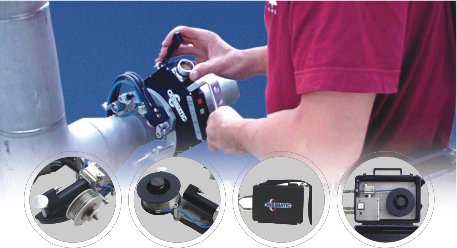
*KD 3-62 con mini bobina para los modelos TP 400 / 600 / 1000.*
